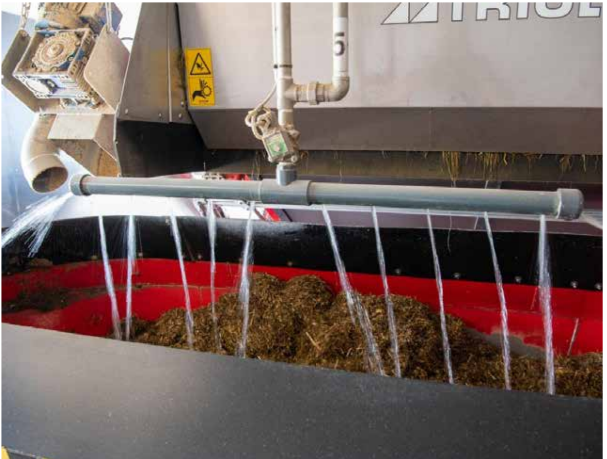
Wasserzuführsystem komplett mit 1 m Sprühbalken
