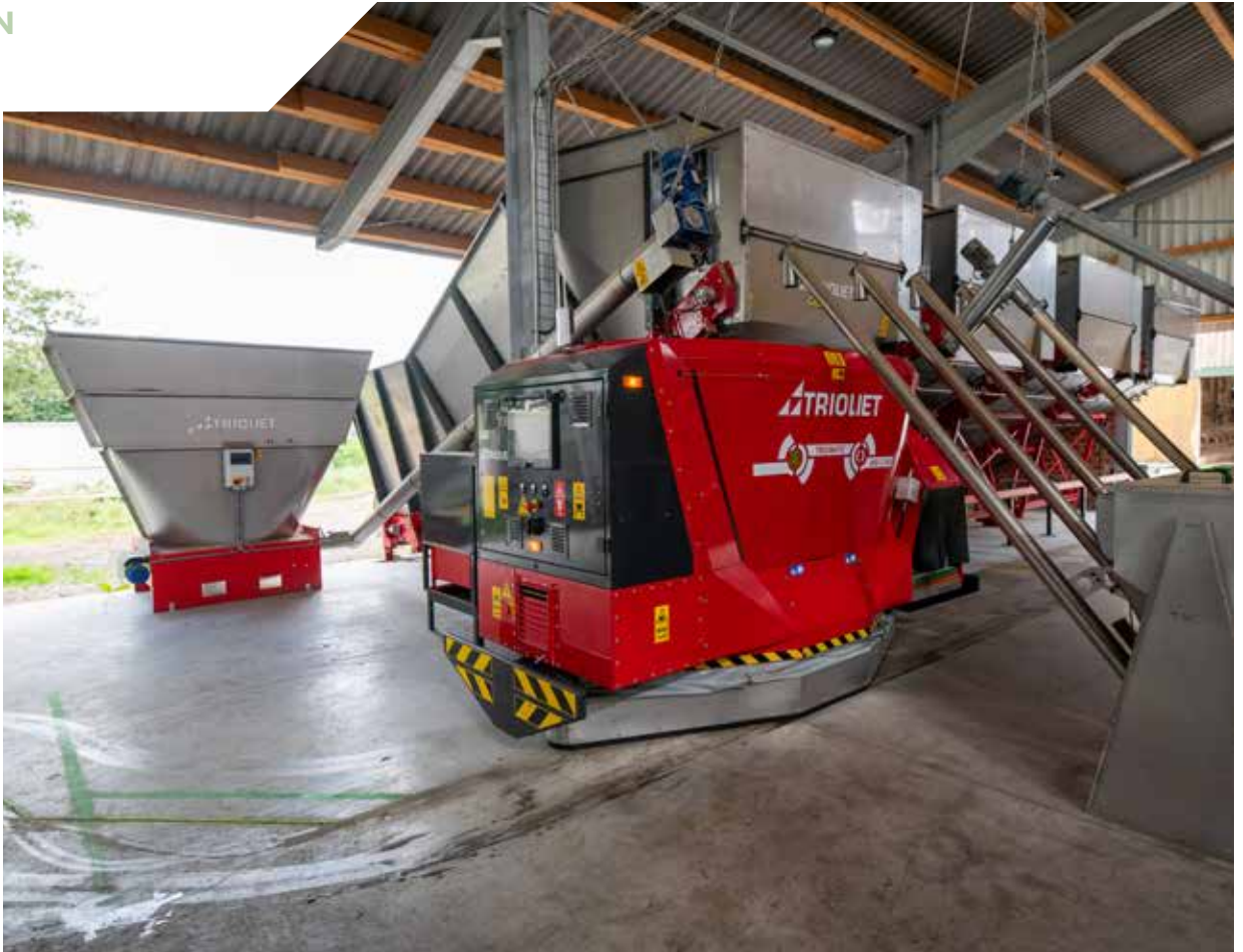
Edelstahl-Schneckendosierbunker mit Rührwerk, Querförderschnecke und Hochförderschnecke
